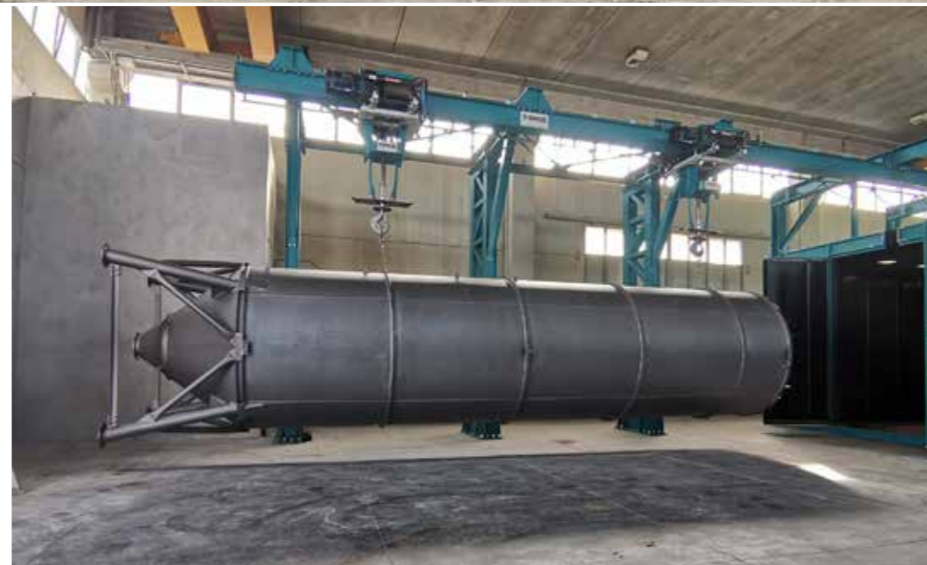
Sopra, sistema di sabbiatura automatizzata per trattamento superfici.
