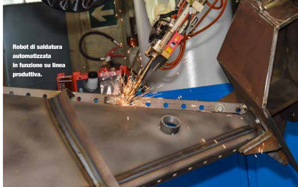
Sistema robotizzato per saldatura automatizzata ad alta precisione.
