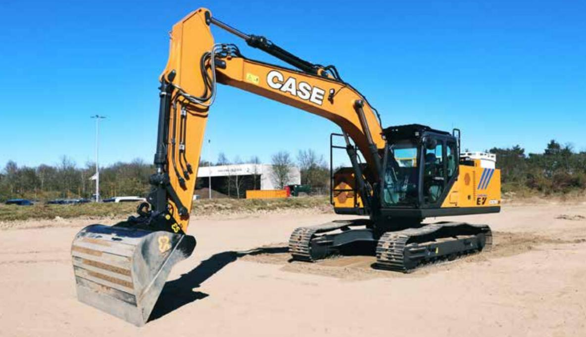
Sviluppato in collaborazione con MOOG, il CX210ZQ è un escavatore elettrico di grandi dimensioni progettato per offrire prestazioni elevate e massima efficienza operativa.
