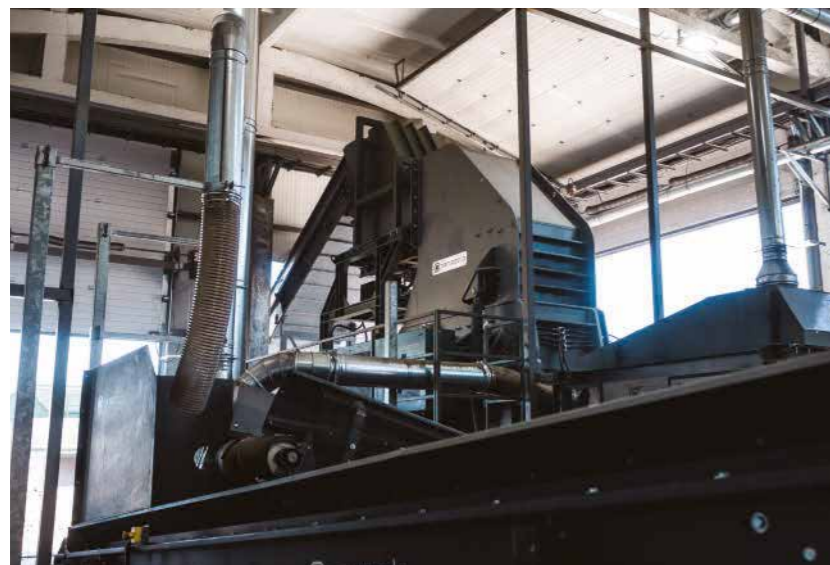
Mulino a martelli Panizzolo Flex 1000 (250 kW - fino a 11 ton/h).
