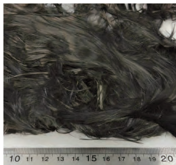
Fig. 4: Materiali compositi dopo i processi di rilavorazione. a) Tessuto non tessuto dopo la cardatura; b) Nastro di fibre allineate con l'HiPerDiF (Cortesia di Lineat Composites)
