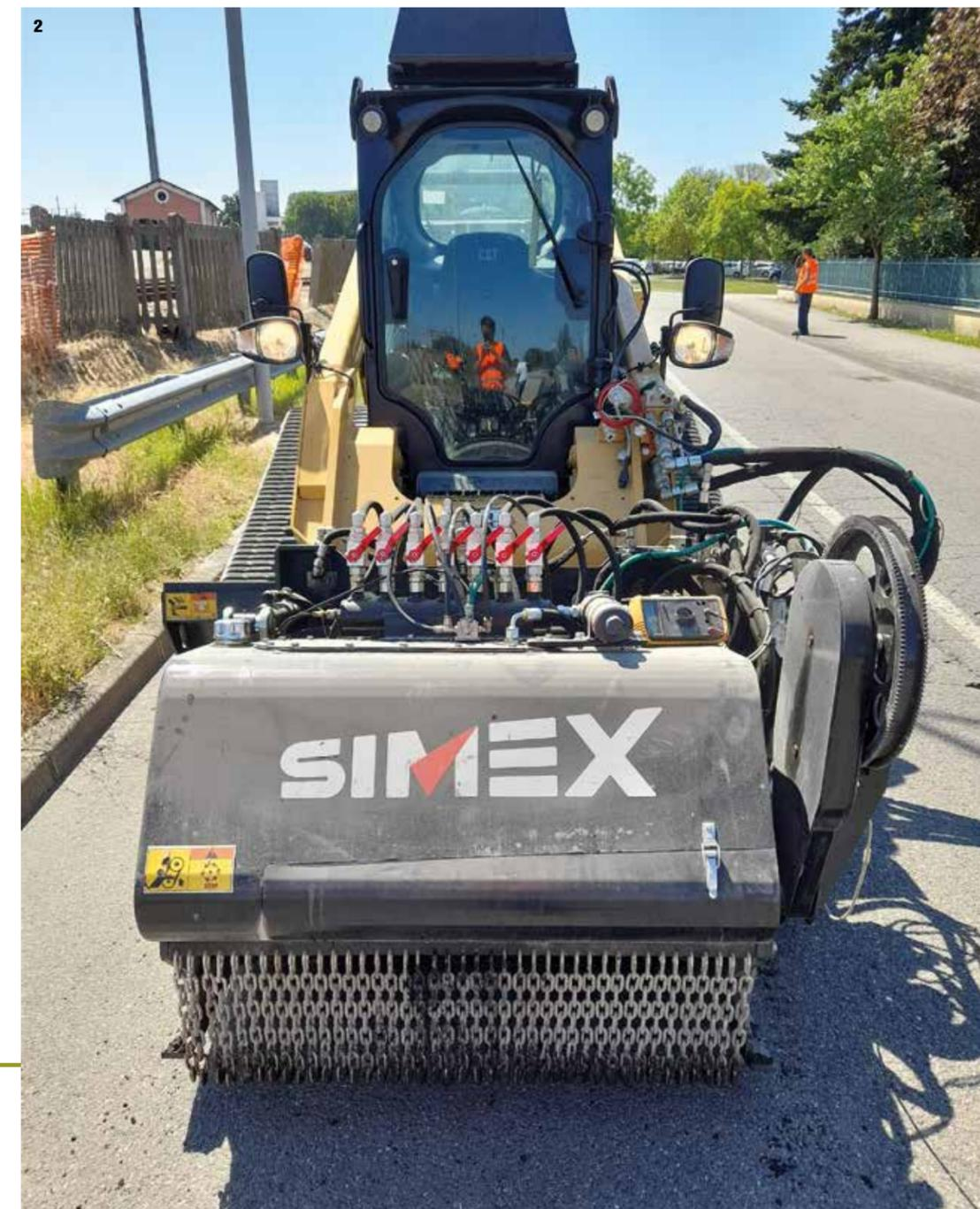
**Fig. 2:** Simex Art è la nuova macchina, ancora in versione prototipo, sviluppata dalla Simex Spa, caratterizzata da una fresa alla quale è stata integrata una mescolatrice.
