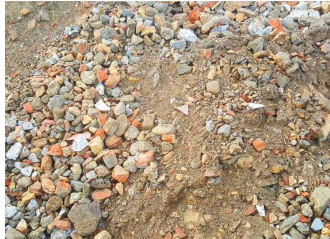
**Aggregato misto riciclato conforme UNI EN 2008. Rappresenta la maggiore produzione tra gli inerti riciclati e viene utilizzato per la realizzazione di sottofondi stradali, rilevati o riempimenti.**
