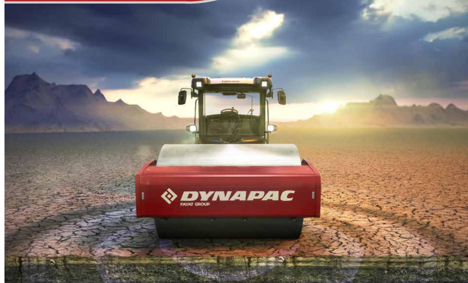
Il nuovo sistema di compattazione SEISMIC applicabile all'intera gamma di Rulli Dynapac Monotamburo, adattando la frequenza di vibrazione alle diverse tipologie di materiali, aumenta la capacità di compattazione. L'abbinamento con il sistema Ecomode garantisce poi un risparmio di carburante fino al 25% e un aumento della vita tecnica del sistema vibrante.
