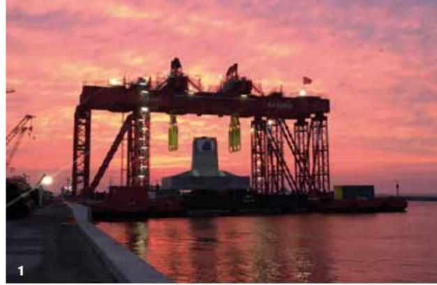
PER INSTALLARE IN MARE APERTO, IN ACQUE DANESI, UN PLINTO DA 1.800 TON FUNZIONALE ALLA REALIZZAZIONE DI UN NUOVO PONTE DI 3,4 KM, FAGIOLI HA SVILUPPATO PER IL CONTRACTOR ITINERA UN CATAMARANO SU MISURA COMPOSTO DA DUE CHIATTE COLLEGATE CON UN APPARATO DI SOLLEVAMENTO DOTATO DI STRAND JACKS E SISTEMA DI SKIDDING.
