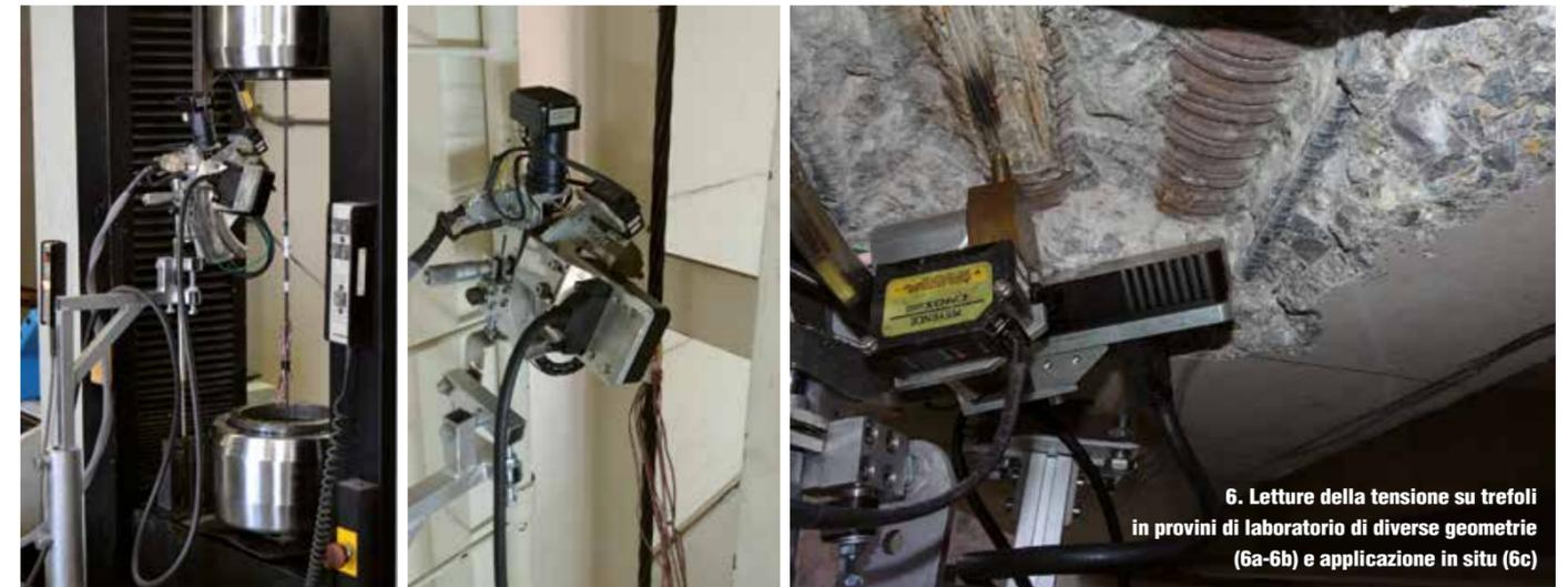
6. Letture della tensione su trefoli in provini di laboratorio di diverse geometrie (6a-6b) e applicazione in situ (6c)
