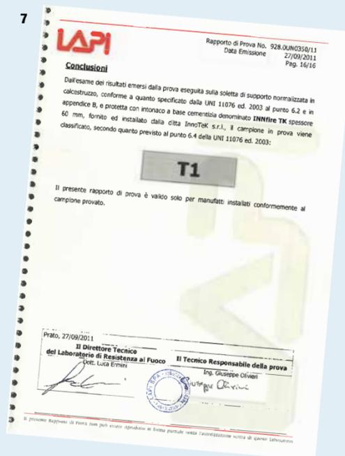
7. Rapporto di prova ok: l'intonaco, per un determinato spessore, ha ottenuto la classificazione T1 secondo la norma UNI 11076
