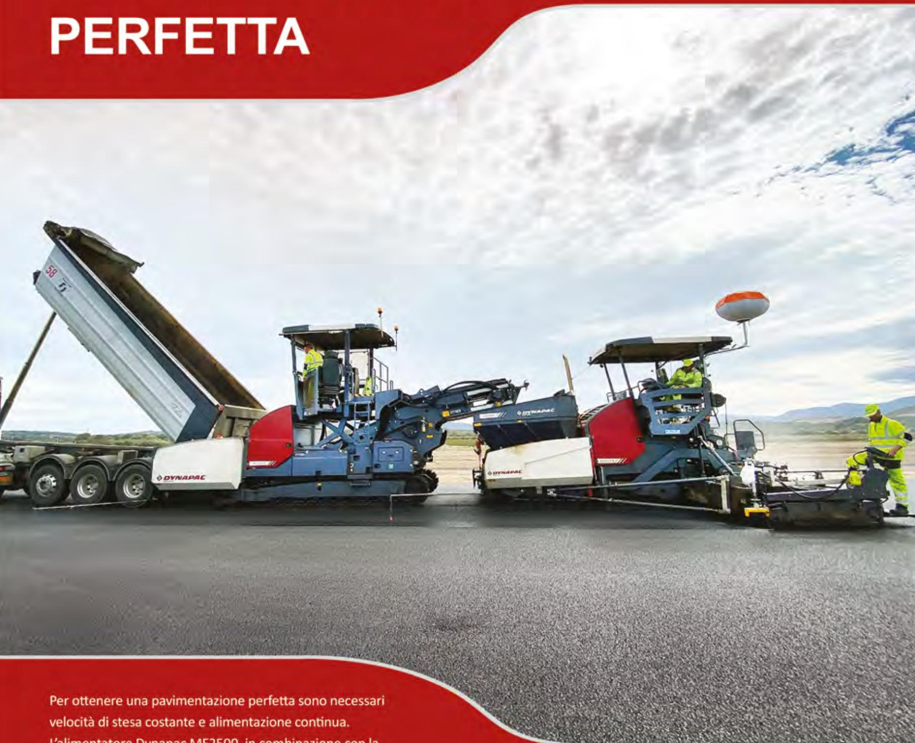
Per ottenere una pavimentazione perfetta sono necessari velocità di stesa costante e alimentazione continua. L'alimentatore Dynapac MF2500, in combinazione con la finitrice Dynapac SD2500WS/CS, può garantire tale risultato. Unico nel suo genere, l'MF2500 ha una base di stesa di 2,5 mt ed è dotato di un nastro brandeggiante con il quale è possibile alimentare due finitrici contemporaneamente.
