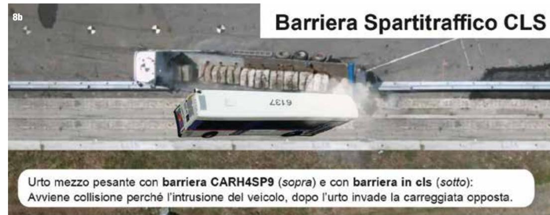
Urto mezzo pesante con barriera CARH4SP9 (sopra) e con barriera in cls (sotto): Avviene collisione perché l'intrusione del veicolo, dopo l'urto invade la carreggiata opposta.
