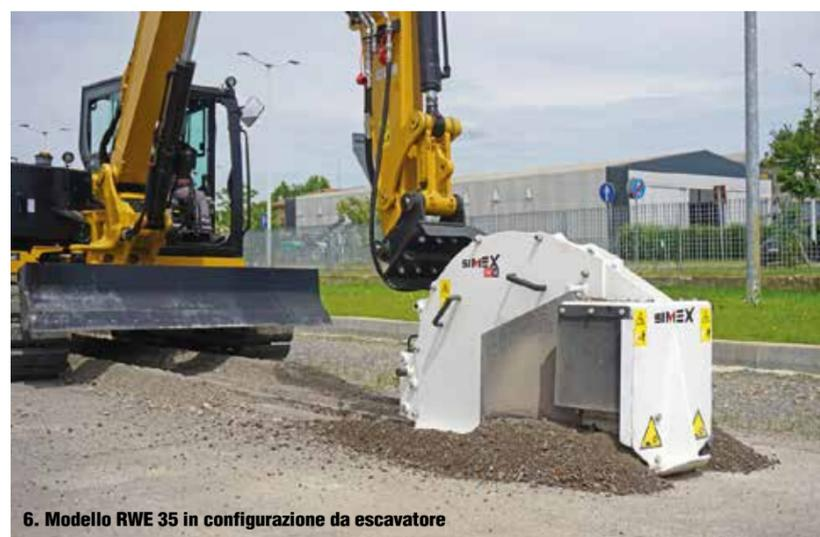
6. Modello RWE 35 in configurazione da escavatore
