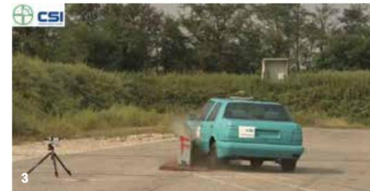
**3. Prova di crash per il terminale**
