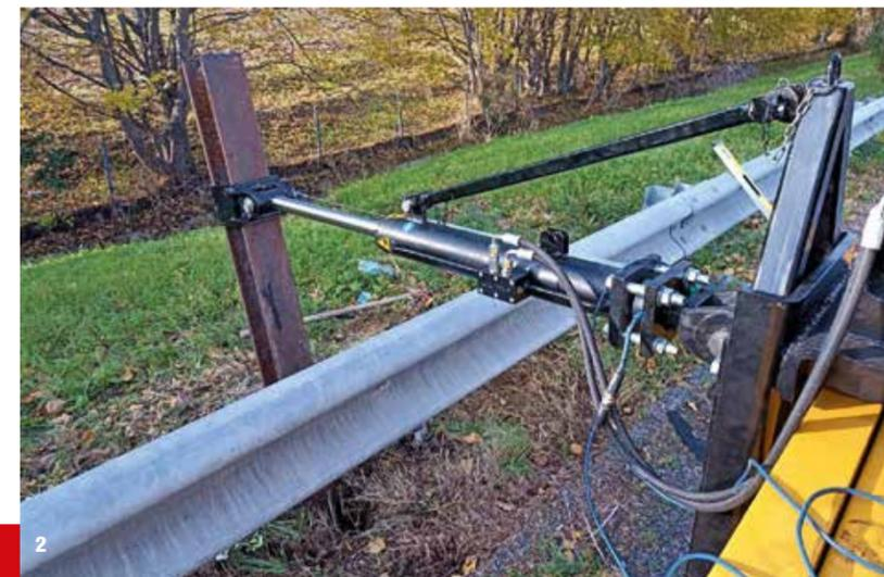
**AISICO METTE A DISPOSIZIONE UN SET COMPLETO DI ATTREZZATURE NECESSARIE ALL'ESECUZIONE DI PROVE DI IMPATTO SEMPLIFICATE SU PALETTO INFISSO, SIA DI TIPO STATICO CHE DI TIPO DINAMICO, TALI DA RISPONDERE AD OGNI ESIGENZA TECNICA SPECIFICA, E ASSICURANDO STRUMENTI DI VALUTAZIONE EFFICACI E FLESSIBILI.**
